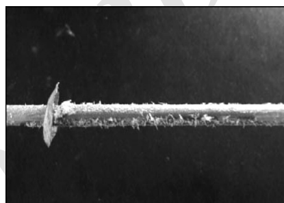
شکل ۳ تصویری از بلورهای جامد سوزنی تشکیل شده در اطراف ترموول راکتور
