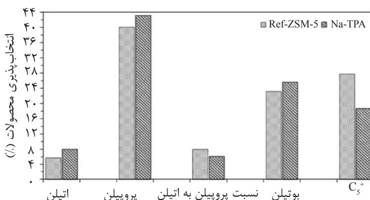
شکل ۷ توزیع محصولات الفینی و هیدروکربنی سنگین در کاتالیست‌های Ref-ZSM-5 و Na-TPA
