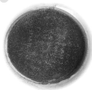
شکل ۳ تصویری از غشای کامپوزیتی دینامیکی از قبل پوشش داده شده قبل از تصفیه پساب نفتی
