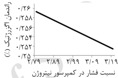
شکل ۴ اثر تغییر در نسبت فشار کمپرسور نیتروژن بر راندمان اگزرتیک
