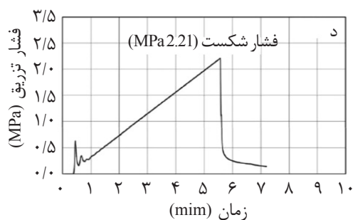
شکل ۱۲ فشار تزریق سیال در طول فرآیند آزمایش‌های شکافت هیدرولیکی الف) آزمایش شماره ۱، ب) آزمایش شماره ۲، ج) آزمایش شماره ۳ و د) آزمایش شماره ۴
