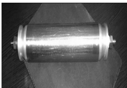
شکل ۲ محفظه شنی ساخته شده از جنس استیل
