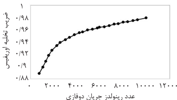
شکل ۲ ضریب تخلیه دبی‌سنج روزنه‌ای به‌ازای عدد رینولدز جریان دوفازی (محدوده تغییرات دبی آب و هوا به ترتیب ۰/۱۲۶ kg/s تا ۰/۰۰۲۷ kg/s و ۰/۰۰۱۰ Pa تا ۰/۰۰۰۰ Pa و دمای محیط)
