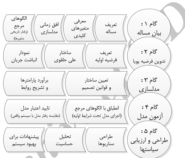
شکل ۱. نمودار روش پویایی‌های سیستمی ارائه‌شده در این مقاله بر اساس روش استرمن
