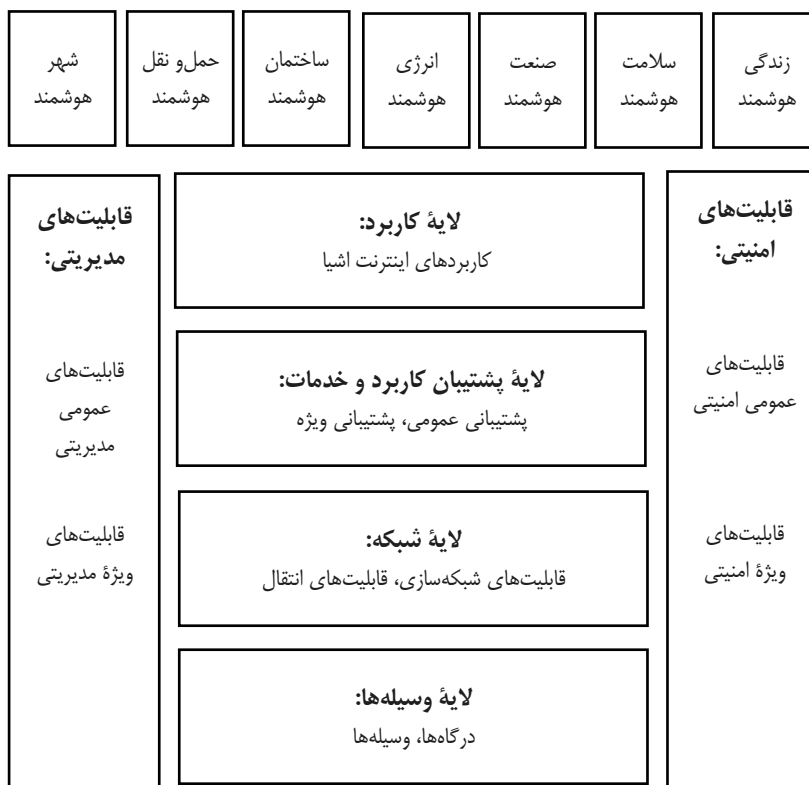
شکل ۱. مدل لایه‌ای معماری اینترنت اشیا (ورمسان و فرایسس، ۲۰۱۴: ۱۵، به نقل از ITU)
