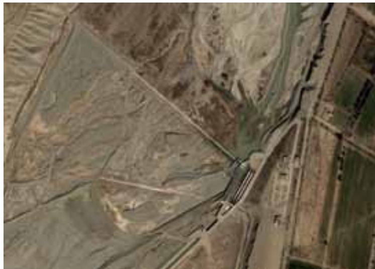
شکل ۱۲ تصویری از سد انحرافی و کانال‌های ایجاد شده در مسیر رودخانه جاجرود هنگام گسترده شدن بر سطح مخروط‌افکنه
