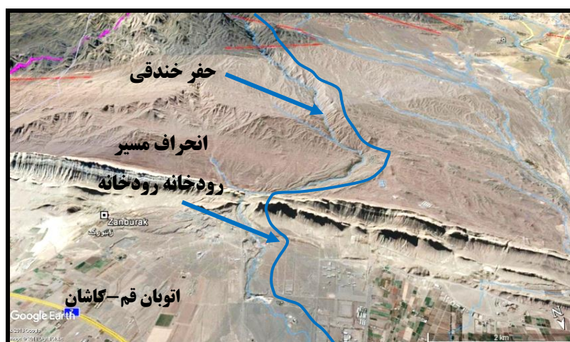
شکل ۹. تغییر مسیر و حفر شدید بستر رودخانه‌ها در غرب زنبورک بر اثر حرکات تکتونیک راست‌گرد گسل کاشان
