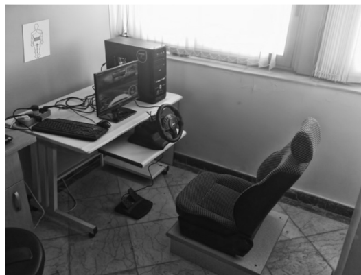
شکل ۱- شبیه ساز رانندگی مورد استفاده در این مطالعه
