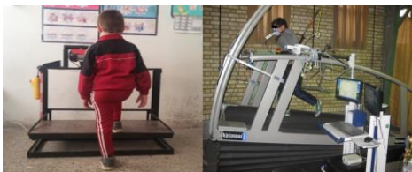
شکل ۱- آزمون استاندارد روی تردمیل به روش گاز آنالایزور و آزمون پلکان فرانسسیس با دستگاه ارگوستپ
