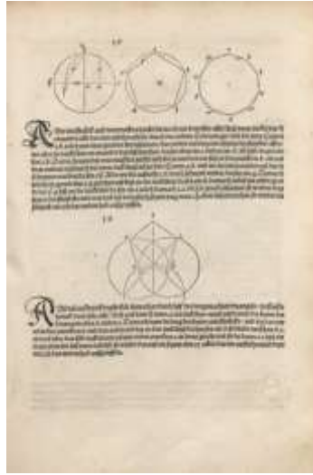
تصویر ۲: روش ترسیم پنج ضلعی منتظم، توسط آلبرش دورر (Fourrey, 1924: 88 & Durer, 1995: 207-208)
