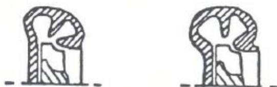
شکل ۲ توربین شعاعی دو ورودی با محفظه متقارن (سمت راست) و غیرمتقارن (سمت چپ) [۱۰]
