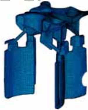
شکل ۷ نقشه شبکه‌بندی شده راهگاه مایع خنک‌کاری
