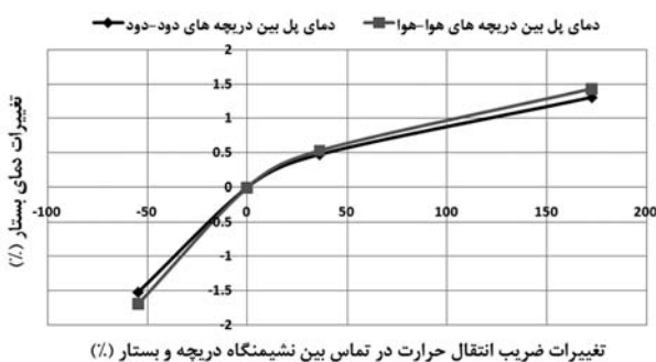
شکل ۲۳ اثر ضریب انتقال حرارت در سطح تماس بین نشیمنگاه دریچه با بستار بر دمای پل بین درجه‌های دود-دود و هوا-هوا
