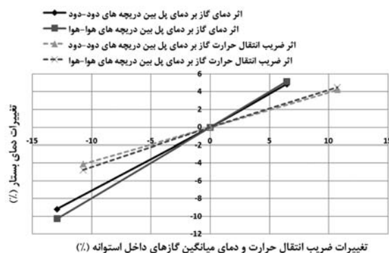
شکل ۹ اثر دمای میانگین و ضریب انتقال حرارت میانگین گازه‌های حاصل از احتراق بر دمای پل بین دریاچه‌های دود-دود و هوا-هوا
