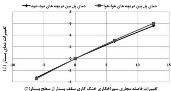
شکل ۲۱ اثر فاصله مجاری سوراخکاری خنک کاری سقف بستار تا سطح شعله بستار بر دمای پل بین درجه‌های دود-دود و هوا-هوا
