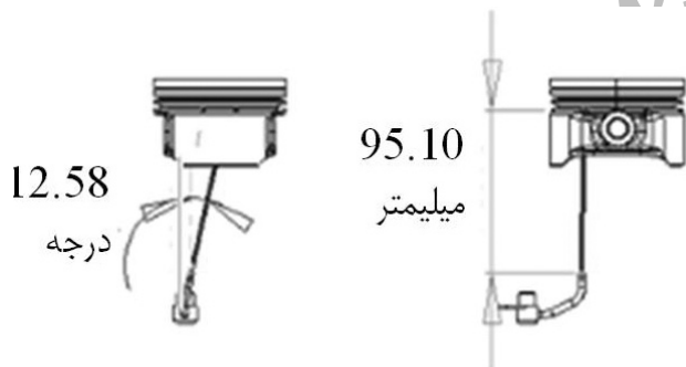
شکل ۴ زاویه پاشش و بیشترین فاصله افشانه تا کف سمبه
