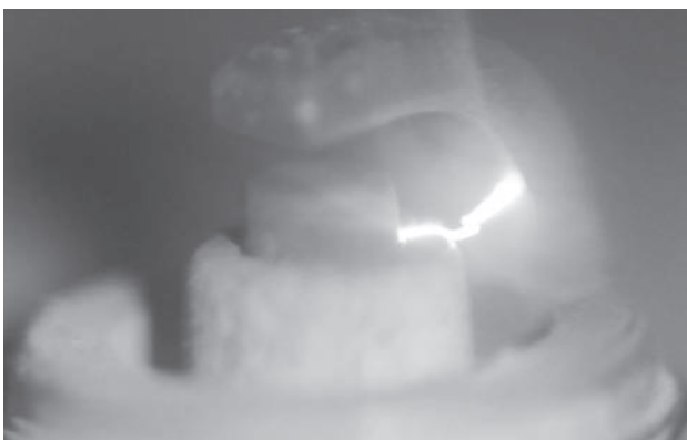
شکل ۱۶ جرقه جانبی در فشار ۸ بار
