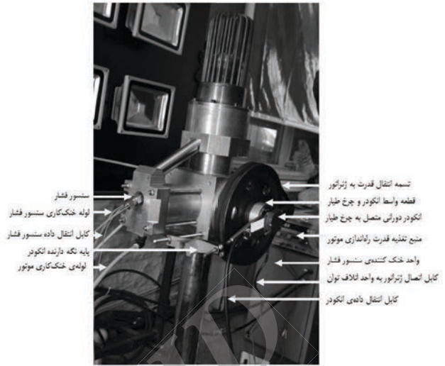
شکل ۱۴ موتور ST500 و تجهیزات داده برداری
