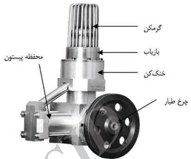
شکل ۲ ب - موتور ST500، از نوع گاما، دارای توان خروجی 500w، حجم کمینه 1.37e-3m^3 ، حجم بیشینه 1.79e-3m^3 و فشار کاری 9bar
