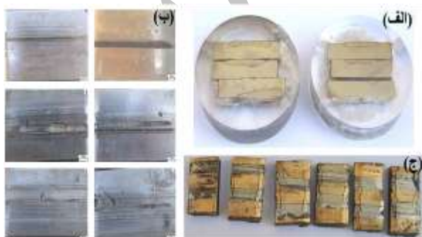
شکل ۲: الف) نمونه‌های مانت شده استفاده شده در متالوگرافی و میکروسختی سنجی، ب) نمونه‌ها بعد از انجام آزمون سایش، ج) نمونه‌های استفاده شده برای بررسی سطوح سایش.
