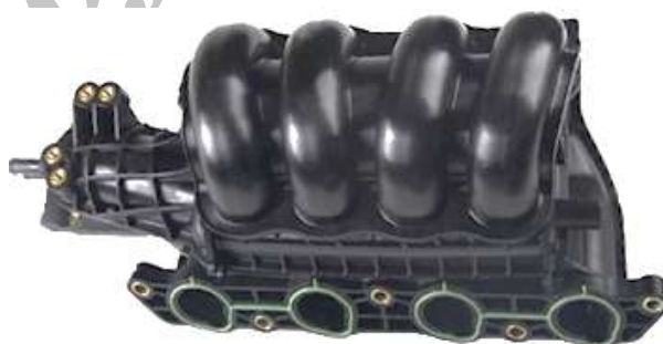
شکل ۱: نمای سه بعدی چندراهه ورودی موتور ملی تیبیا
