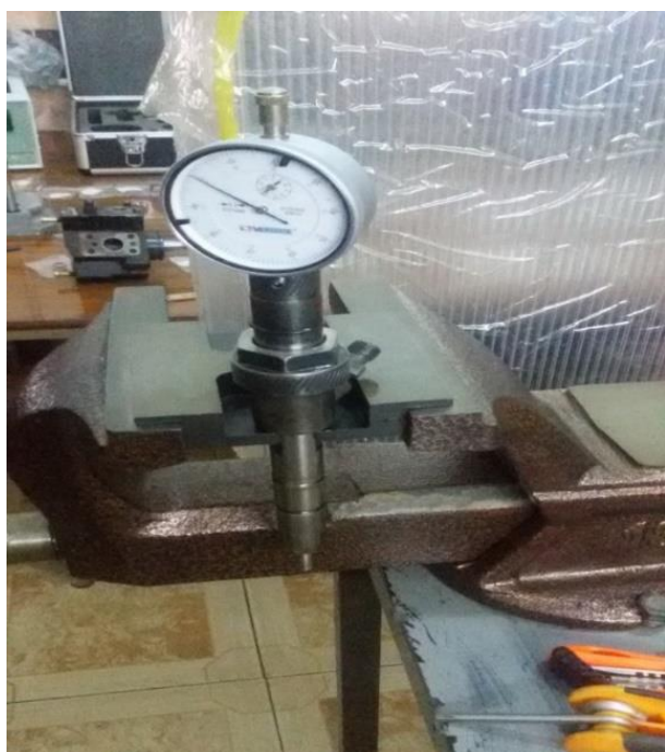
شکل ۸: دستگاه آزمون فشار افشانه سوخت
