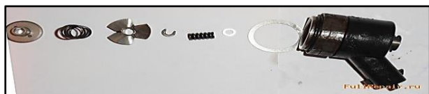
شکل ۳: مجموعه آهنربا و جزئیات بکار رفته در افشانه سوخت
