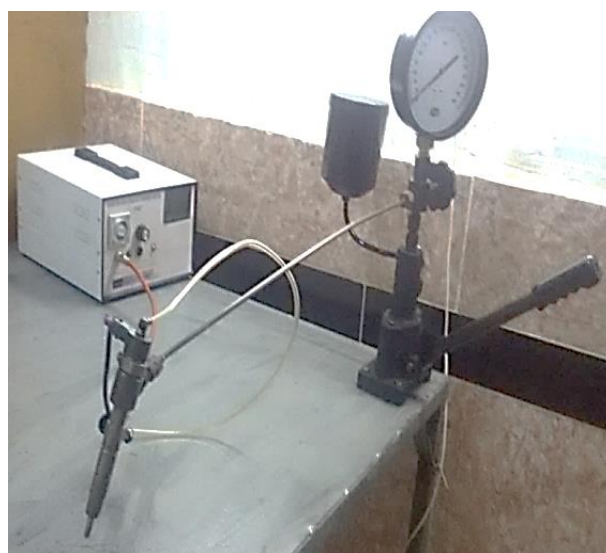
شکل ۷: دستگاه آزمون نحوه پاشش افشانه سوخت
