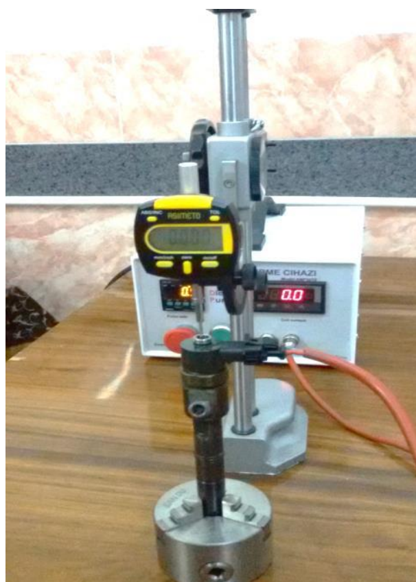
شکل ۶: دستگاه آزمون لایه
