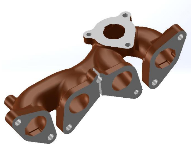
شکل ۱: شکل اولیه چندراهه دود چدنی موتور EF7-TC
