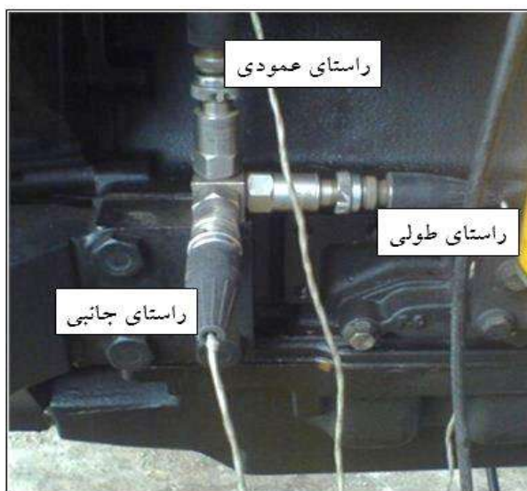
شکل ۳: نحوه اتصال شتاب‌سنج‌ها به موتور
