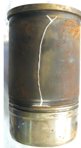
الف. ترک طولی (از رنگ برای وضوح ترک استفاده شده است)
