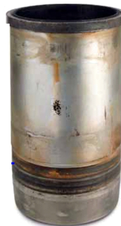
شکل 2: پدیده pitting ناشی از حفره‌زایی در سطح خارجی استوانه [6]
