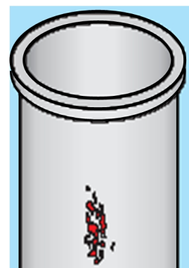
شکل 2: پدیده pitting ناشی از حفره‌زایی در سطح خارجی استوانه [6]
