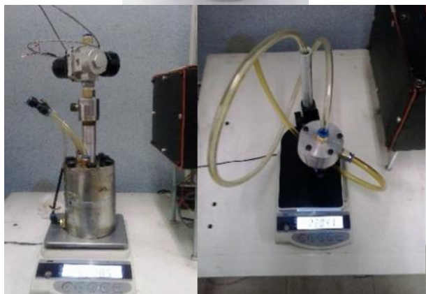
شکل ۱۲: وزن کردن تجهیزات آزمایش با ترازو با دقت \pm 0,1 mg
