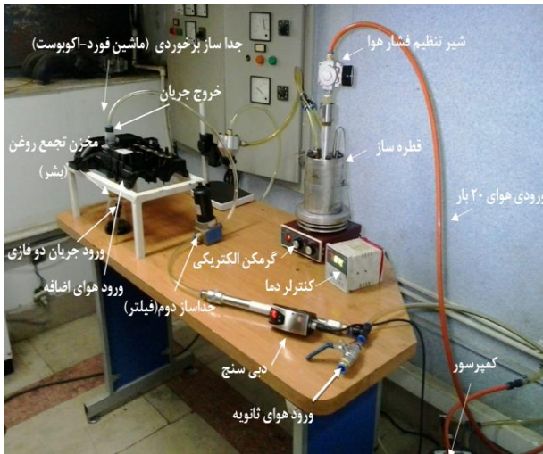
شکل ۶: چیدمان آزمایشگاهی جدا ساز برخوردی ماشین فورد- اکوبوست
