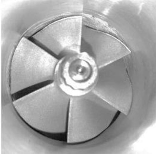
شکل ۱۵. آثار برخورد پروانه تنجار با محفظه
