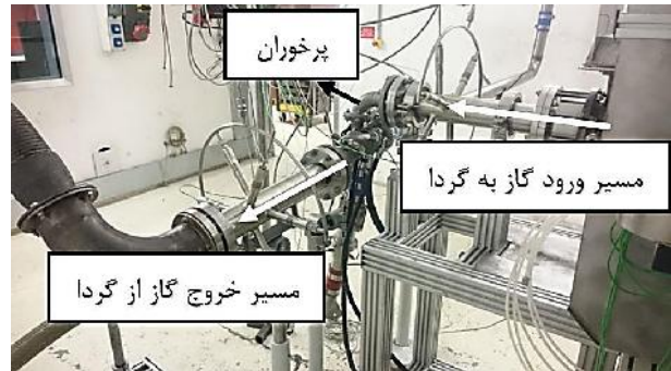
شکل ۶. نمای از اتاق آزمون بعد از نصب پرخوران
