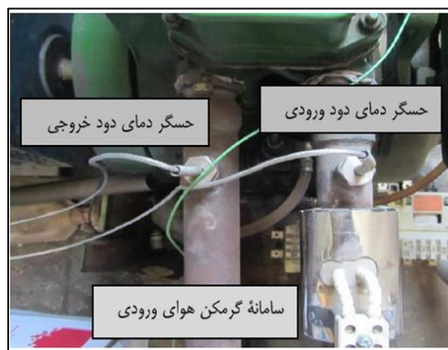
شکل ۱: سامانه گرمکن هوای ورودی و حسگرها
