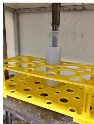
شکل ۳: شست و شوی گرد با تولوئن به کمک فراصوت
