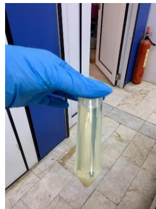
شکل ۲: نانوگردد جمع‌آوری شده به کمک سانتریفیوژ
