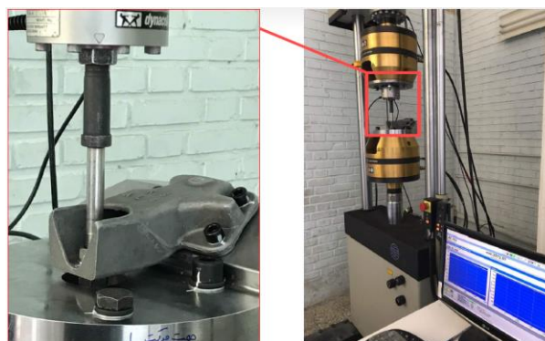
شکل ۲: ثابت کننده و پایه دسته موتور نصب شده بر روی دستگاه اینسترون
