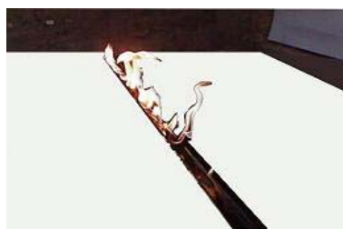
شکل ۱- گسترش شعله در سینی
