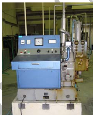
شکل ۱- نمایی از موتور دیزل CFR ستان‌سنج
