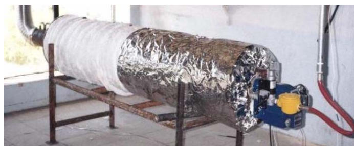
شکل ۲- کوره آزمایشگاهی در هنگام استفاده از سوخت متان
