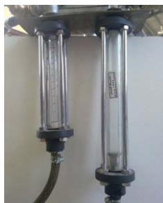
شکل ۳- تصویر رواترهای اندازه گیر دبی سوخت و هوا
