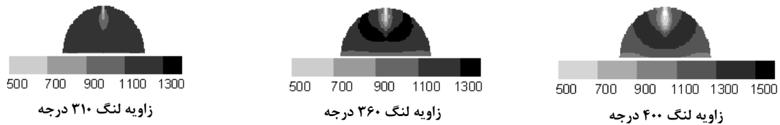
شکل ۹- توزیع دما در فاز جامد محیط متخلخل در چند زاویه لنگ
