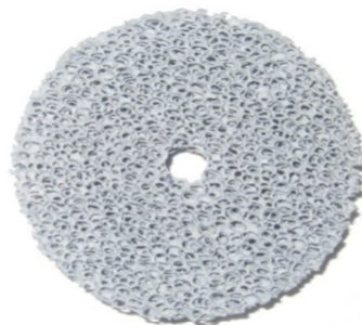
شکل ۳- محیط متخلخل سوراخ شده از جنس سرامیک SiC
