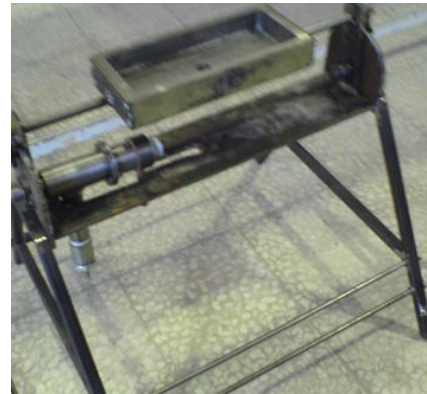
شکل ۲- الف) پایه نگهدارنده مشعل به همراه مخلوطکن سوخت و هوای طراحی شده ب) طرحواره دستگاه آزمایش
