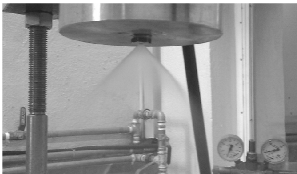
شکل ۱۱- تصویر پاشش سیال از انژکتور ساخته شده
