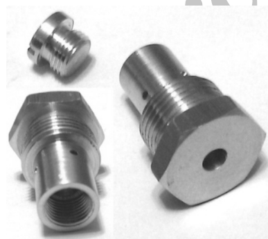
شکل ۴ - نمونه‌ای از انژکتور ساخته شده
