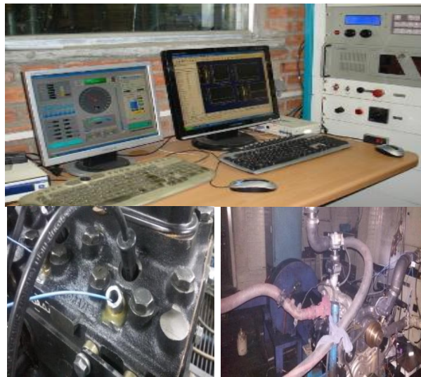
Figure 1- Research test cell and in-cylinder pressure measurement equipment شکل ۱- سلول آزمون تحقیقاتی و تجهیزات اندازه گیری فشار داخل محفظه احتراق
