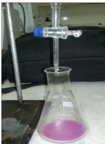
Figure 2- Titration using phenolphthalein detector شکل ۲- تیتراسیون به کمک شناساگر فنول فتالین
