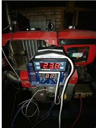
Figure 4- Exhaust gas temperature measurement by PT100 sensor شکل ۴- اندازه گیری دمای گازهای خروجی اگزوز توسط حس گر PT100
