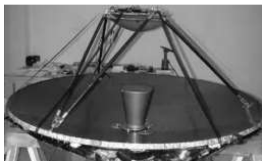
شکل ۲- نمایی از صفحه آنتن انعکاسی دارای پوسته ساندویچی ضخیم [۸]
