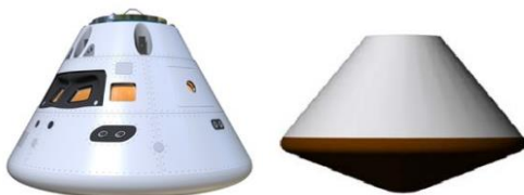
شکل ۱ - شمایی از شکل هندسی بلانت (چپ) و ایروشل (راست)
