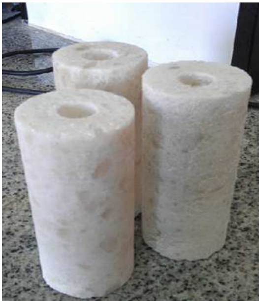
شکل ۴. نمونه آماده شده برای آزمایش خزش
