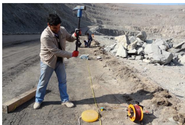
شکل 6. نمایی از پروفیل لرزه‌ای اجرا شده جهت ایجاد و ثبت امواج طولی در معدن چغارت
