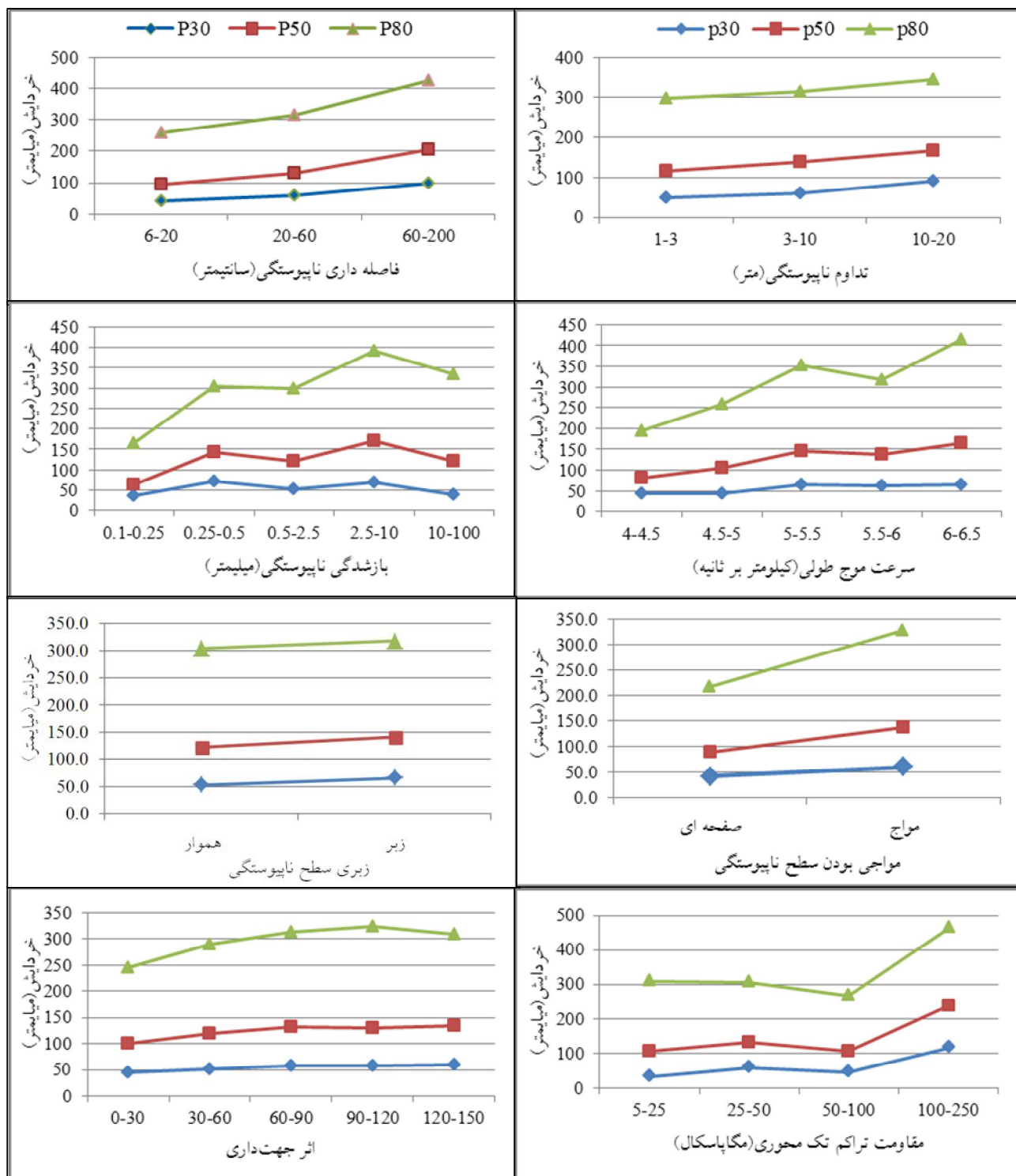
شکل 9. اثر خصوصیات توده سنگ بر اندازه خردایش حاصله
