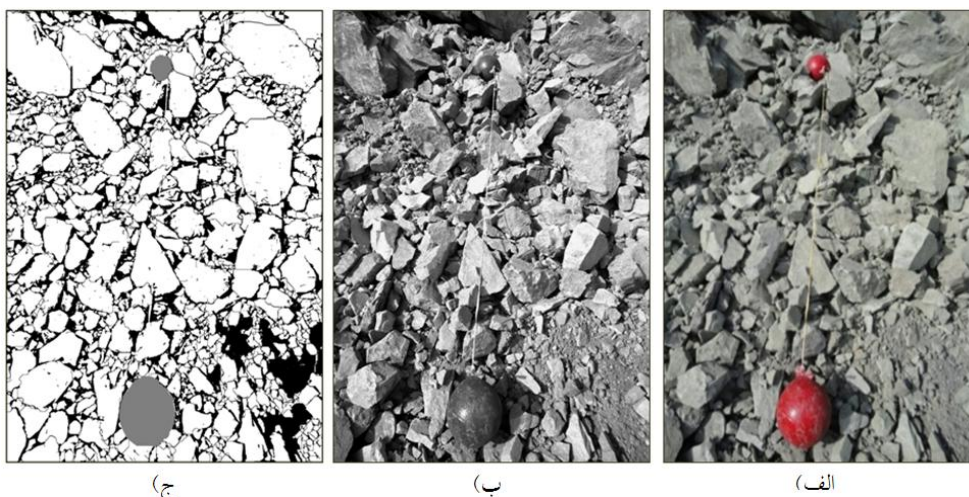
شکل 7. الف) تصویر اولیه کپه انفجاری ب) تصویر مقیاس خاکستری ج) تصویر دودویی پس از ترسیم و ویرایش
