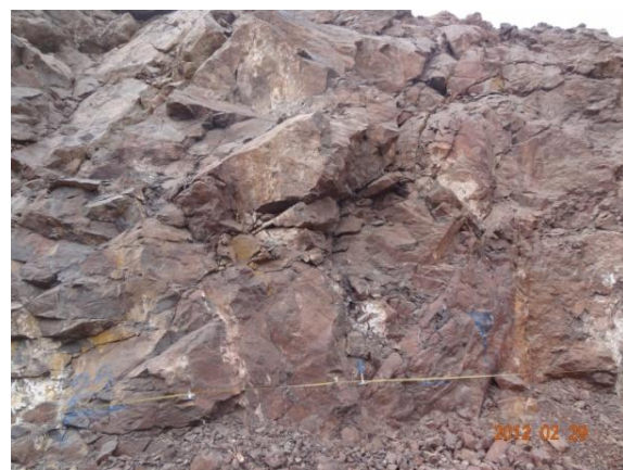
شکل 3. نمایی از خط پیمایش پیاده شده بر روی توده‌سنگ‌های معدن چغارت، راست) ماده معدنی، چپ) باطله
