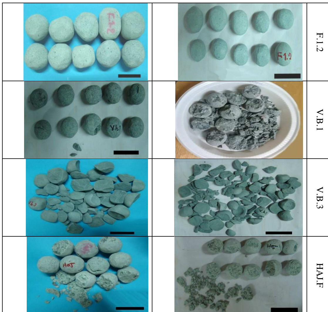
شکل ۴. تغییرات در شکل و اندازه نمونه‌های دوام بعد از ۵ سیکل از انجام آزمون دوام در چرخه‌های ۳۰ و ۶۰ آزمون ذوب و انجماد ( کلیه عکس‌های سمت چپ مربوط به چرخه ۳۰ ذوب و انجماد و عکس‌های سمت راست مربوط به چرخه ۶۰ ذوب و انجماد می‌شوند).
