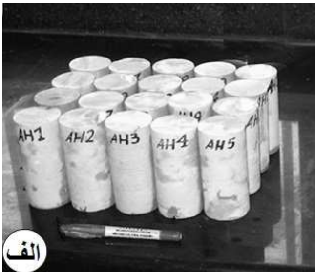
شکل ۵. نمونه‌های انتخابی برای آزمایش شکست هیدرولیکی سازند آسماری، (ب) ابعاد گمانه ایجاد شده در نمونه
