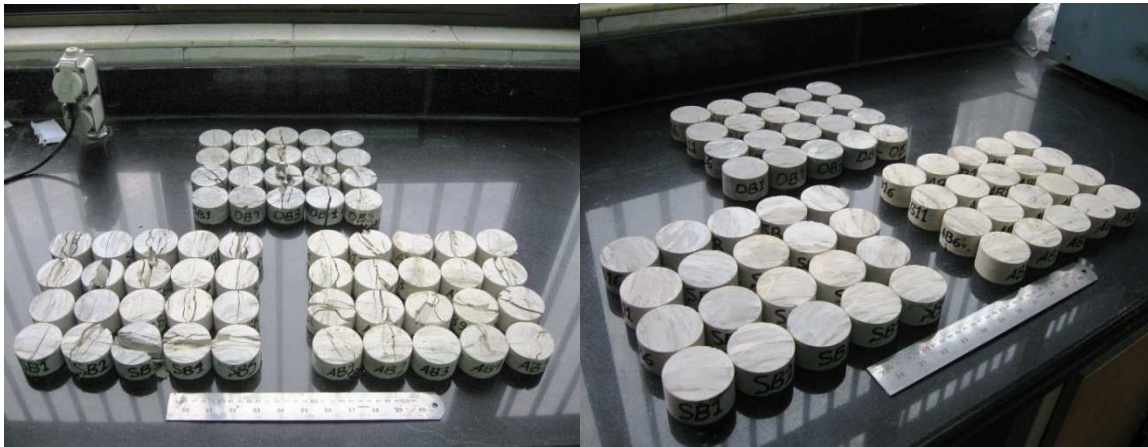
شکل ۹. نمونه‌های آزمایش مقاومت کششی برزیلی در حالت قبل و بعد از آزمایش
