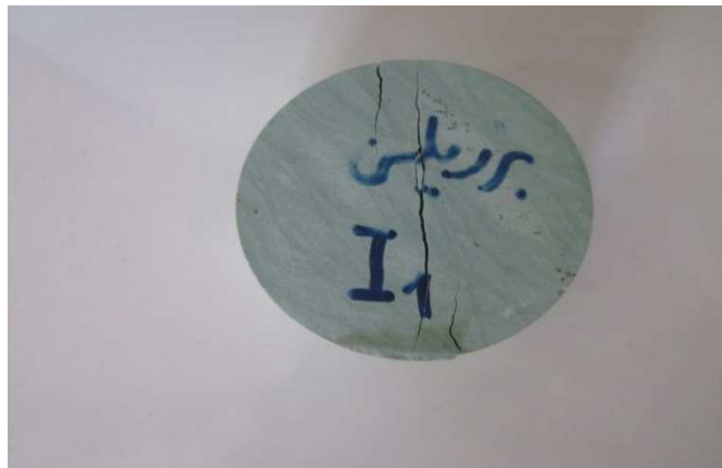
شکل ۴. نحوه شکست نمونه در آزمایش برزیلی
