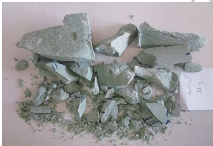
شکل ۳. نحوه شکست نمونه در آزمایش مقاومت تراکمی تک محوری
