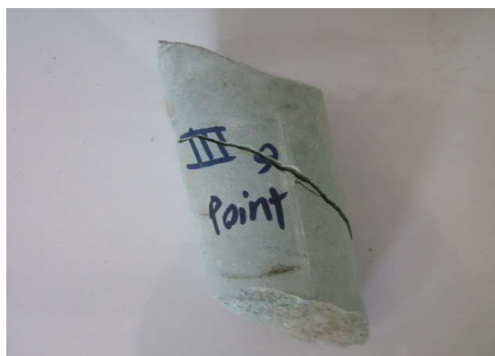
شکل ۵. نحوه شکست نمونه در آزمایش بار نقطه‌ای
