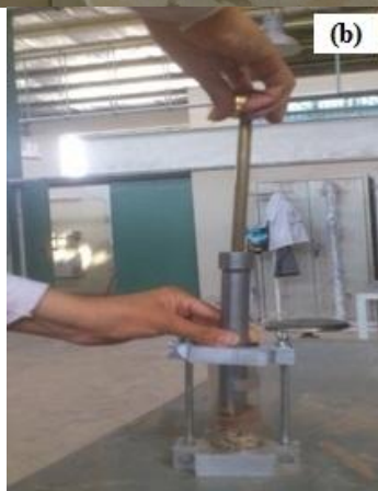
شکل ۵. الف) تجهیزات تراکم هاروارد، ب) نحوه تراکم کردن نمونه آزمایش پین‌هول به وسیله چکش هاروارد
