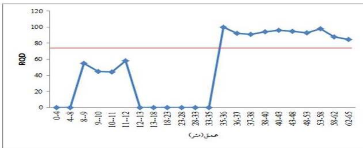
شکل ۱۲. نمودار خطی تغییرات شاخص کیفی توده سنگ با عمق در گمانه شماره ۱۰ به عمق ۶۵ متر
